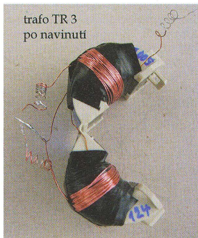
Obr. 6. Výstupní transformátor navinutý na zaklapávacím toroidu
