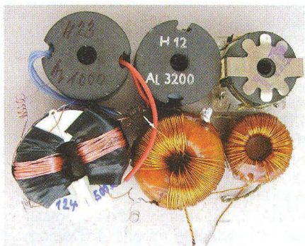
Obr. 5. Různá provedení výstupního transformátoru TR1 impulsního zdroje
